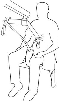
Ziehen Sie den rechten Beinhalter durch den Gurt am linken Beinhalter. Überkreuzen Sie die beiden Gurte, und ziehen Sie einen Beingurt durch den anderen. An den vorderen Haken des Bügels an der Hebevorrichtung befestigen.
