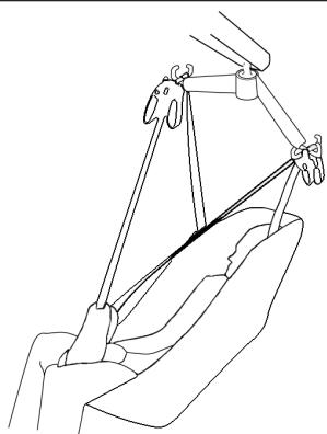
Levante la eslinga a la altura deseada y sujeté las correas de los hombros como se muestra en la ilustración. A continuación podrá levantar al paciente a la altura deseada. Al sentar al paciente, puede utilizarse la agarradera de la parte posterior de la eslinga para asegurar que la postura sea buena.
